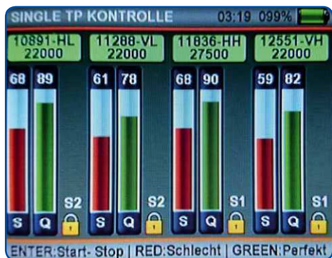
Schneller Überblick: Der Check von vier repräsentativen Transpondern für die vier Polarisationssebenen eines Satelliten
